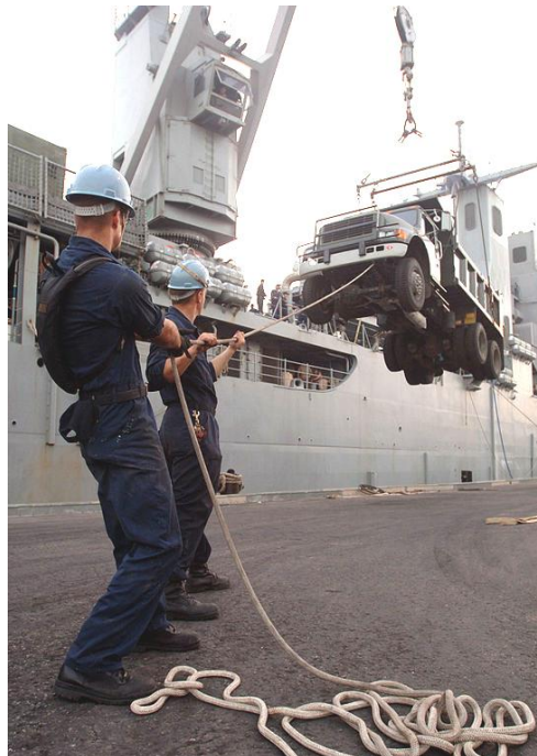
FIGURA 12: TRABAJADORES QUE USAN LÍNEAS DE ETIQUETAS PARA GUIAR LA CARGA DURANTE UNA OPERACIÓN DE ELEVACIÓN
