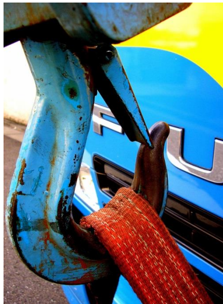
FIGURA 11: GANCHO DE GRÚA CON PESTILLO DE SEGURIDAD CERRADO. FOTO DE TANAKAWHO, CC BY 2.0
